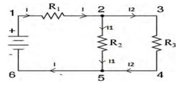
Fig. 1.4.5. Series-Parallel Circuits
