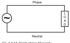
Fig. 1.4.14. Single phase AC supply
