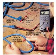
Fig. 6.1.6. Open circuit
