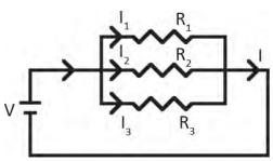
Fig. 1.4.4. Parallel Circuits
