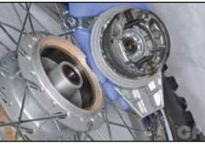
Fig: 2.3.15.1 Drum Brake
