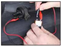
Fig: 2.3.5.6.4 Testing the Solenoid
