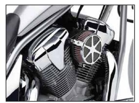
Fig: 2.3.5.3.2 Air Filter System
