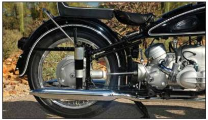
Fig: 2.3.9.1 Propeller Shaft System
