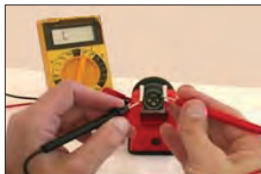
Fig: 3.3.10.4.2 Testing of Mic.
