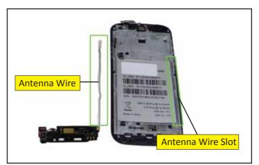
Fig: 3.3.5.10 Antenna Wire
