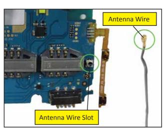
Fig: 3.3.6.8.3 Antenna Wire Slot
