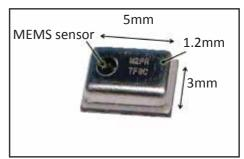
Fig: 3.3.16.7 Barometer
