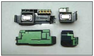
Fig: 3.3.8.1.1 Mobile phone Antenna -1
