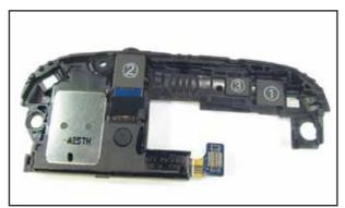
Fig: 3.3.8.1.2 Mobile phone Antenna -2
