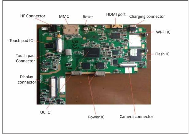
Fig: 3.3.8.13.7 Tablet PCB
