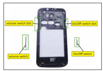
Fig: 3.3.6.9.2 On/Off Switch
