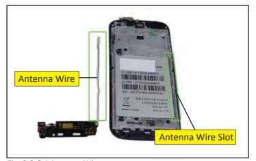
Fig: 3.3.6.4 Antenna Wire
