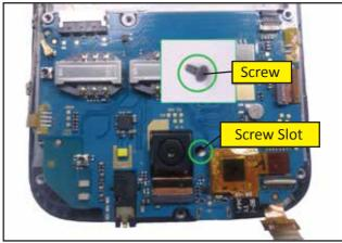
Fig: 3.3.6.8.2 Screw Slot
