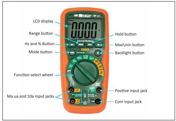
Fig: 3.3.4.10.1 Digital Multimeter
