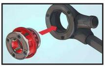
Fig-2.1.28 Die Header Placement
