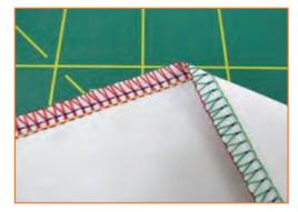
Fig 2.2.8(b): Five-Thread Overlock
