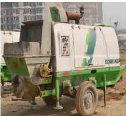
Fig. 4.1.14. Concrete Pump
