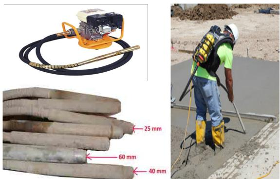
Fig. 4.2.4. Needle Vibrator
