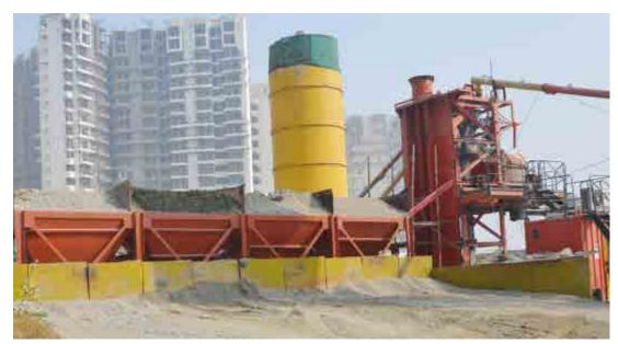
Fig. 4.1.10. Batching Plant
