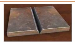
Fig. 4.2.2.1 - Butt Joint
